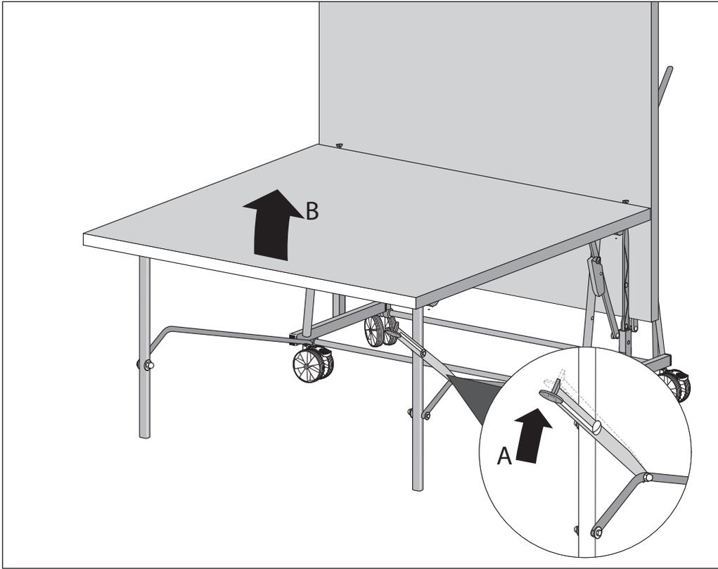
**D** Drücken Sie den Hebel der Standsicherung nach oben und heben Sie die Plattenhälfte an. Behalten Sie in der Anfangsphase des Hochklappens den Druck bei.
