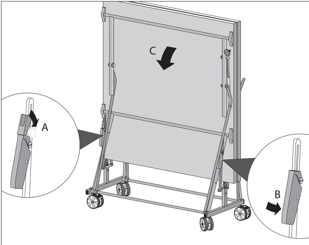
**D** Drücken Sie die linke Kippsicherung und legen Sie den Feststellknebel um. Anschließend die Platte mit einer Hand festhalten, rechte Kippsicherung drücken und Platte langsam herunterklappen (Platte unter keinen Umständen einfach fallen lassen!).
